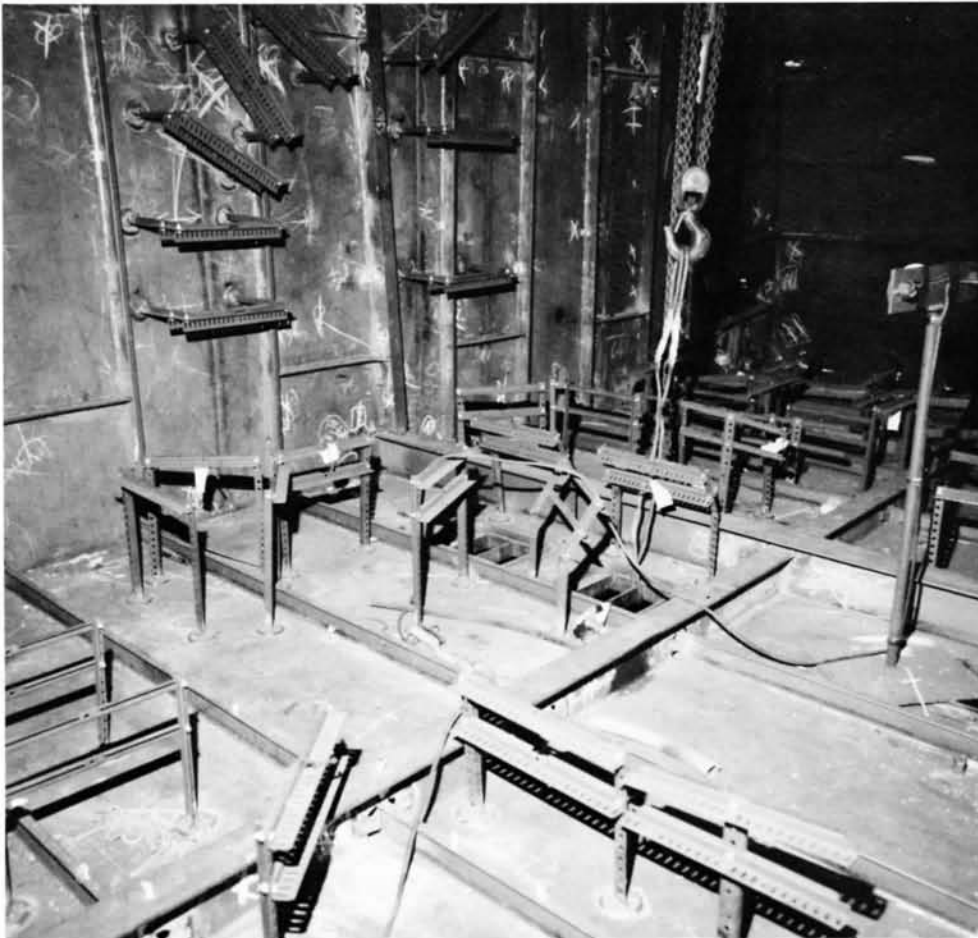
Produit manufacturé — Les supports de câbles utilisés dans tout le navire sont fabriqués en lots. Les articles sont ensuite réunis par élément pour la pose à l'étape de pré-armement à chaud de la construction.
