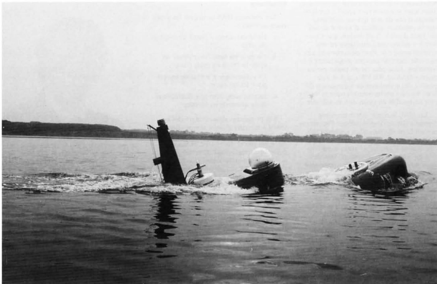
Figure 5. Seahorse : sous-marin de poche expérimental.
