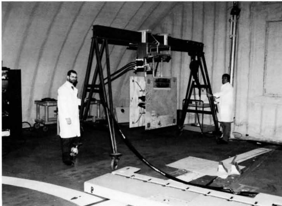
Les techniciens d'Indal Technologies manoeuvrent un hélicoptère simulé pour démontrer l'intégration des éléments de hardware et de software du système d'appontage d'hélicoptère RAST Mk III. On voit le dispositif d'amarrage rapide au premier plan, tandis qu'à l'arrière-plan, on aperçoit la caméra de détection à infrarouge, juste à la gauche des planches auxquelles sont attachées les balises. (Photo fournie par Indal Technologies Inc.)
