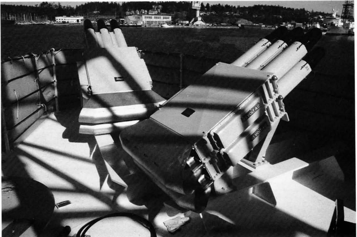
Trois lanceurs de CMÉ Shield produisent un intéressant effet d'ombres sur l'extension de la plate-forme de conduite du tir tribord du *Restigouche*. Le système Shield, installé en vue de l'Opération Friction II, protégera le navire contre les menaces de missiles pendant l'opération Barrier. Des blindages d'absorption radar ont été installés autour des montants et des rampardes. (Photo par le Lcdr R.B. Houseman)
