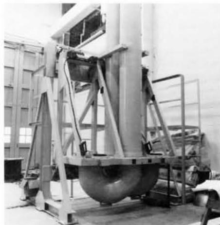
Ce lanceur Mk 48 pour navires a été intégré à la nouvelle installation d'essai à terre, à Halifax. (Photo de la BFC Halifax)
