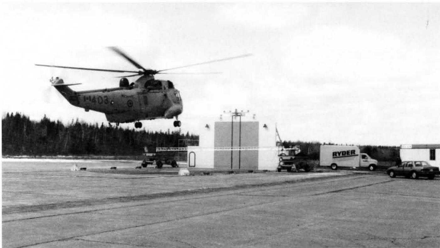
En préparation de l'essai à terre du système de détection de position et du système de repères visuels pour le pilote, à la BFC Shearwater, la maquette d'un hangar et d'un pont d'envol de destroyer de la classe 205 est exposée au souffle d'un hélicoptère Sea King. (Photo du CETM, par Peter Michetti)
