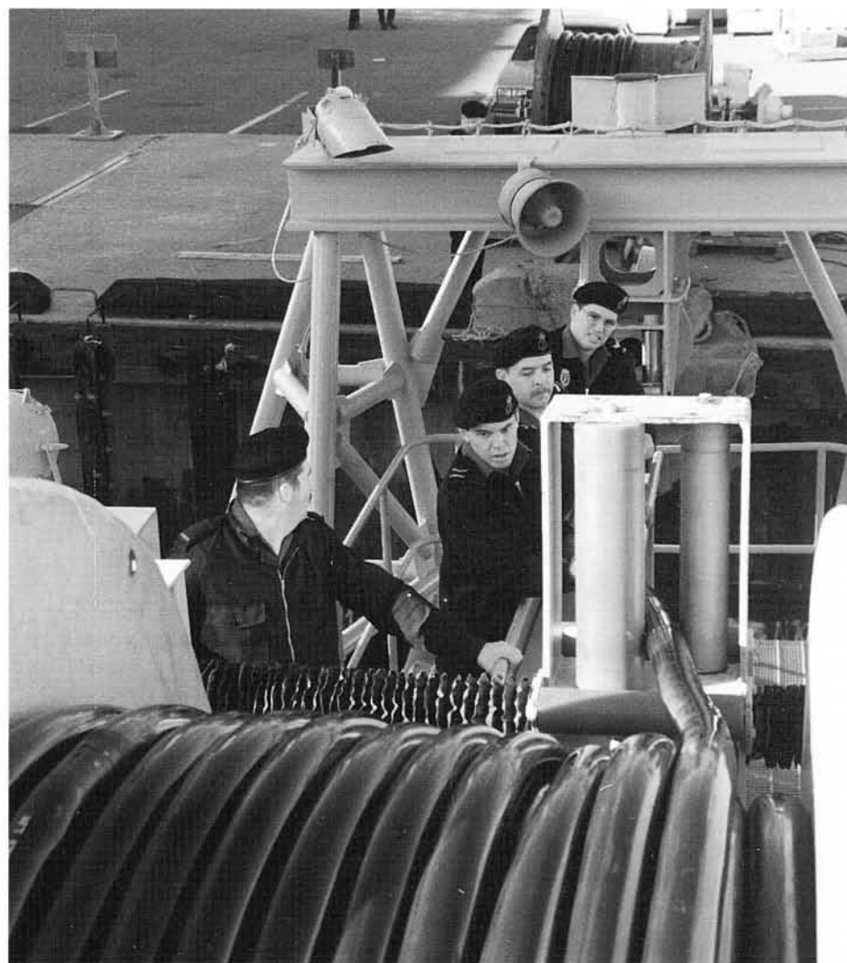
Des techniciens d'armes navales débarquent le réseau remorqué du NCSM Fraser au chantier d'Halifax. On peut voir le câble qui traverse le tambour du treuil, se rend vers l'arrière par l'horizontale, monte par les chaumards tournants du régulateur d'enroulement et sort à l'arrière du navire par un chaumard évasé.
