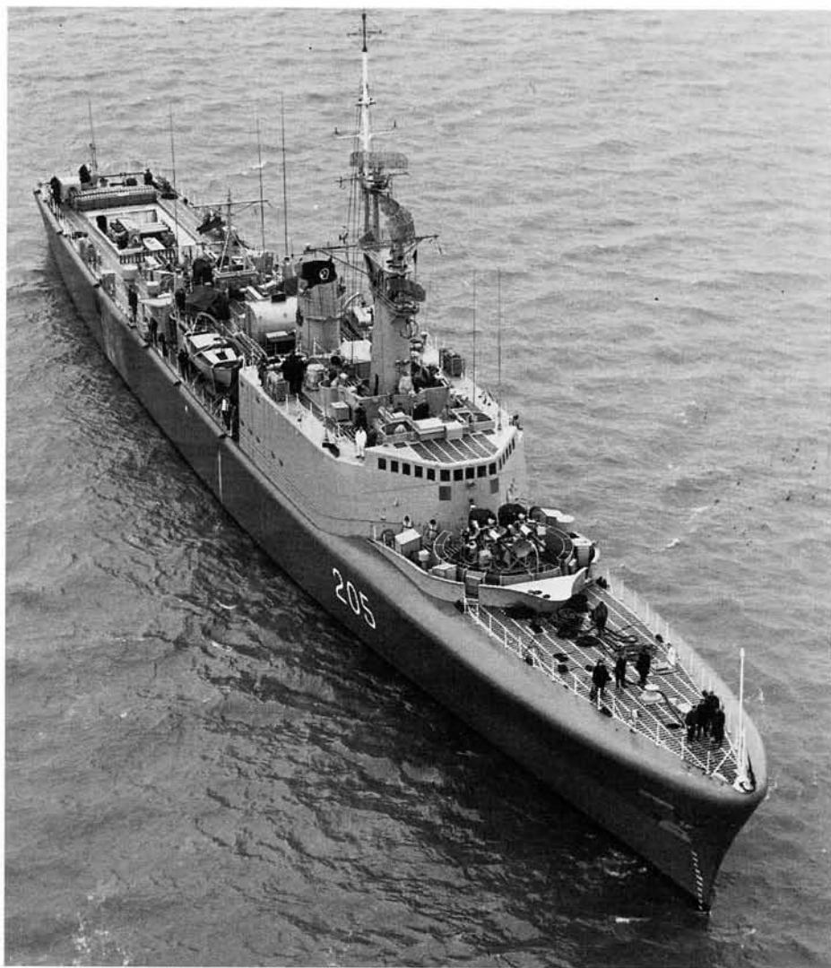
Sur cette photo du NCSM Saint-Laurent , probablement prise en 1956, on remarque les affûts des mortiers tritubes GASM Limbo reposant horizontalement et immobilisés en position de chargement dans le puits arrière ainsi que l'absence d'abris de canon en fibre de verre sur les tourelles des canons avant et arrière.
