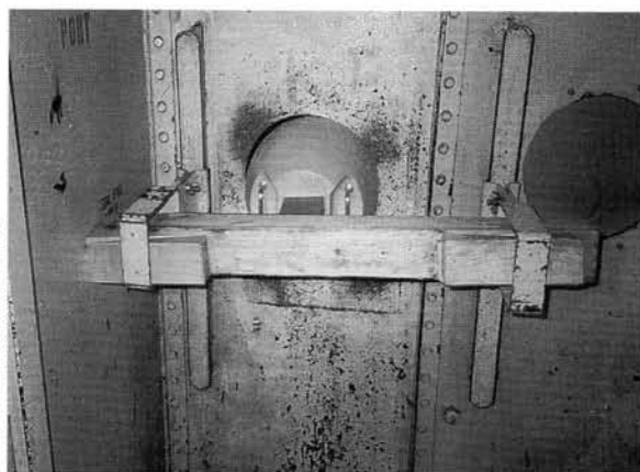
Fig. 2. Une boîte pare-éclats en composite verre-résine de 350 mm faisant l'objet d'une évaluation à la Division de l'organisation sécurité de l'ÉGNFC(E).
