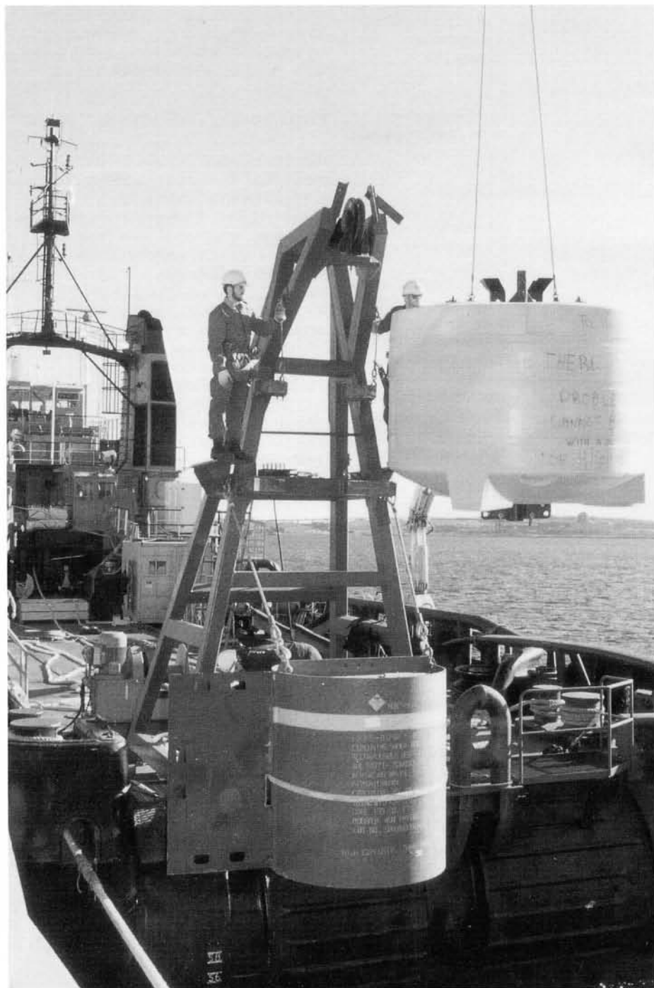
Fig. 2. Les manutentionnaires au Dépôt de munitions des Forces canadiennes à Bedford, en N.-É., procèdent au chargement, sur un chevalet spécial, à bord du NAFC Riverton , d'un flotteur servant à suspendre la charge. (Photo : le cplc M. Ray, BFC Halifax ).
