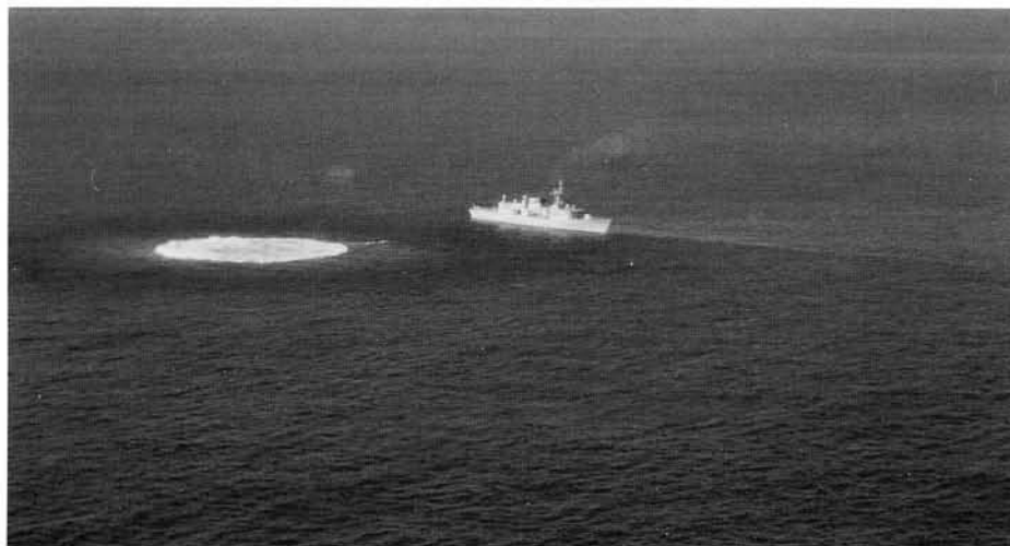
La troisième explosion : Ces photos montrent les effets de l'onde de choc initiale heurtant la surface (au-dessus), la formation du panache (au centre) et la formation d'une vague de surface de trois mètres. (Photos de la BFC Halifax)
