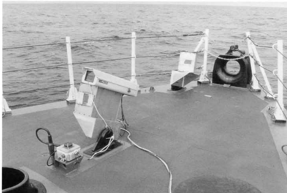
Cette caméra à haute vitesse, installée à l'avant, a servi, ainsi que plusieurs autres, à enregistrer les détails de l'effet dynamique des détonations sur le navire. (Photo de la BFC Halifax par le cpl R. Duguay)
