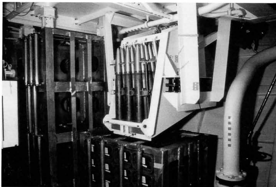
On peut apercevoir certains instruments sur le râtelier d'obus de 57 mm à accès direct. Noter les appareils de mesure de force g à droite des obus inertes. Ces appareils de mesure, qui sont faciles à lire, fournissent des données plutôt limitées. Noter le boîtier en aluminium des accéléromètres piézorésistifs montés au-dessus de l'appareil d'éclairage à lumière rouge, à gauche sur la photo. (Photo du CETM par George Csukly).
