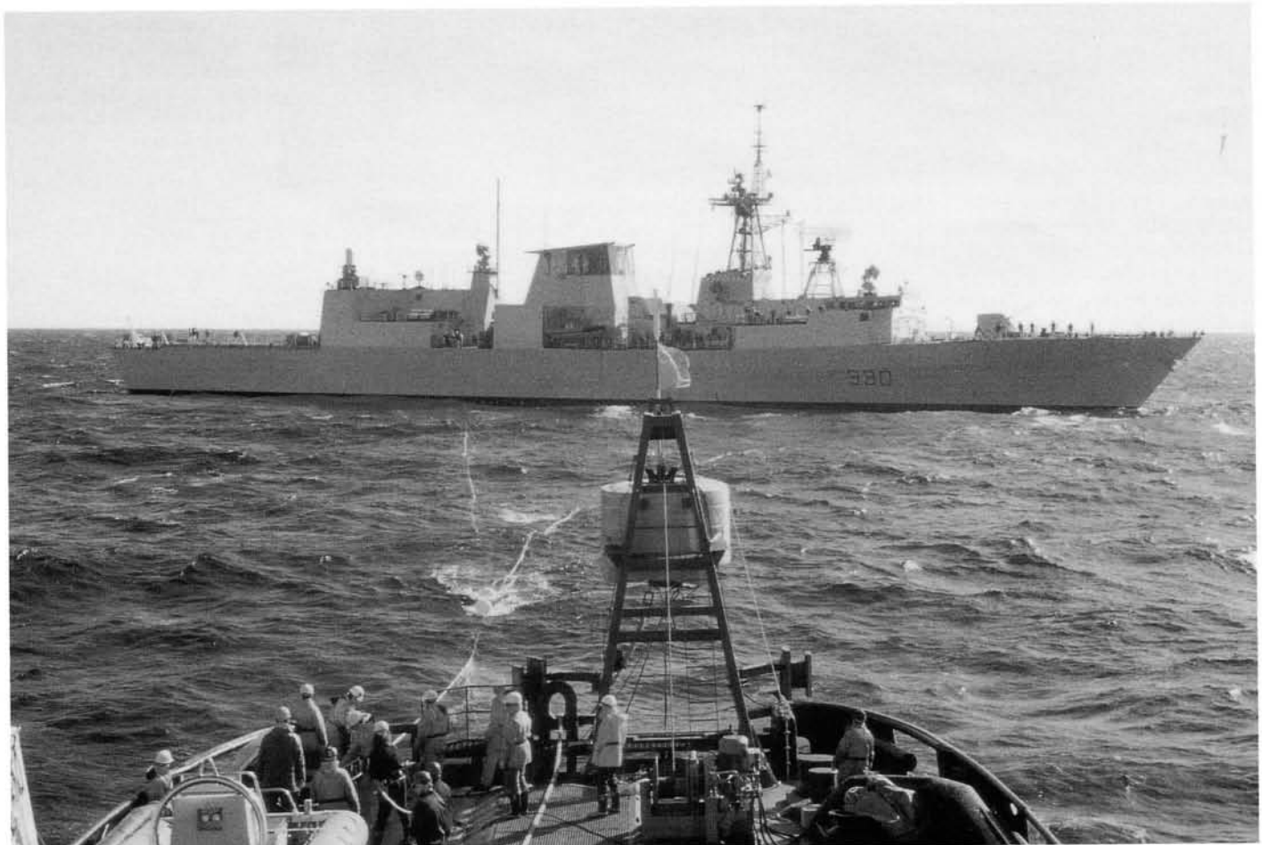
Figure 5. Derniers préparatifs : le NCSM Halifax se place en travers par rapport à la poupe du Riverton . Les câbles servant à déployer la patte d'oie sont ensuite hissés sur le Riverton (photo fournie par la BFC Halifax).
