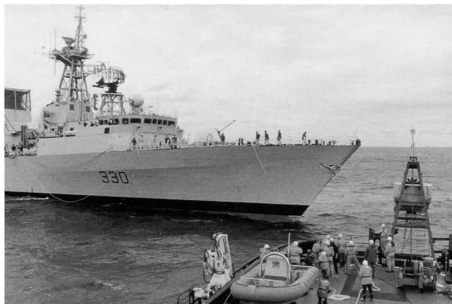
Des câbles sont lancés du NCSM Halifax vers le Riverton en préparation d'une explosion. Le flotteur de la charge est visible sur la grue, mais la charge proprement dite a été armée et abaissée en profondeur. (Photo de la BFC Halifax par le quartier-maître [première classe] M. Ray)
