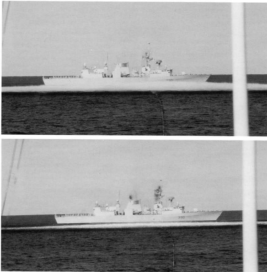
Figure 6. Troisième explosion : Cinq tonnes d'explosifs ont été utilisées lors de l'essai final dans le cadre du programme de résistance aux chocs. Les charges ont été placées de façon à ce que les chocs soient répartis uniformément sur l'ensemble du navire. (Photo : BFC Halifax)
