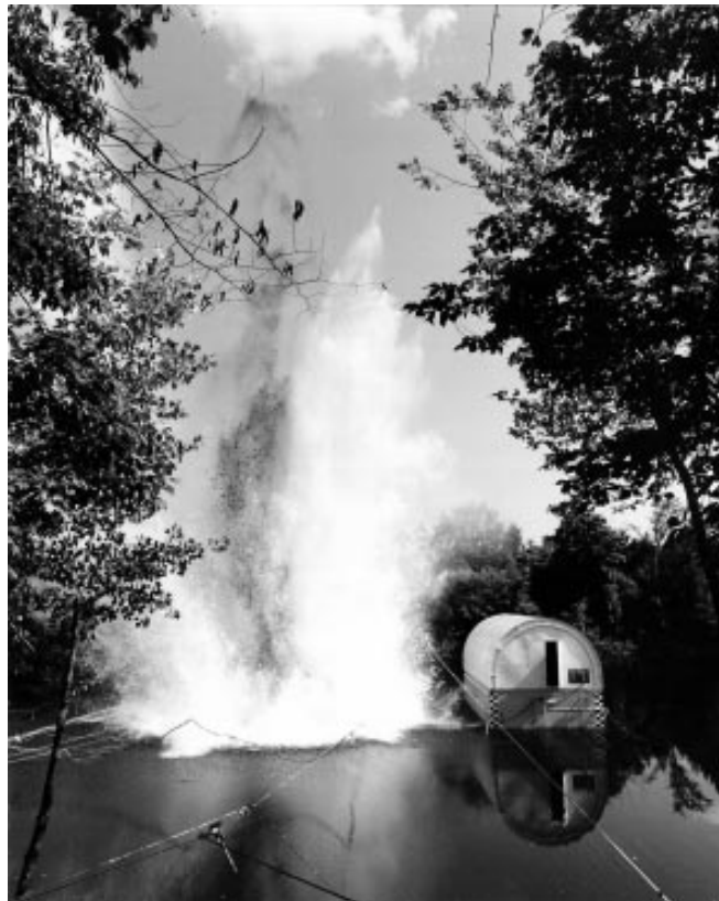
Les essais de chocs lourds sont effectués sur une plateforme flottante.
