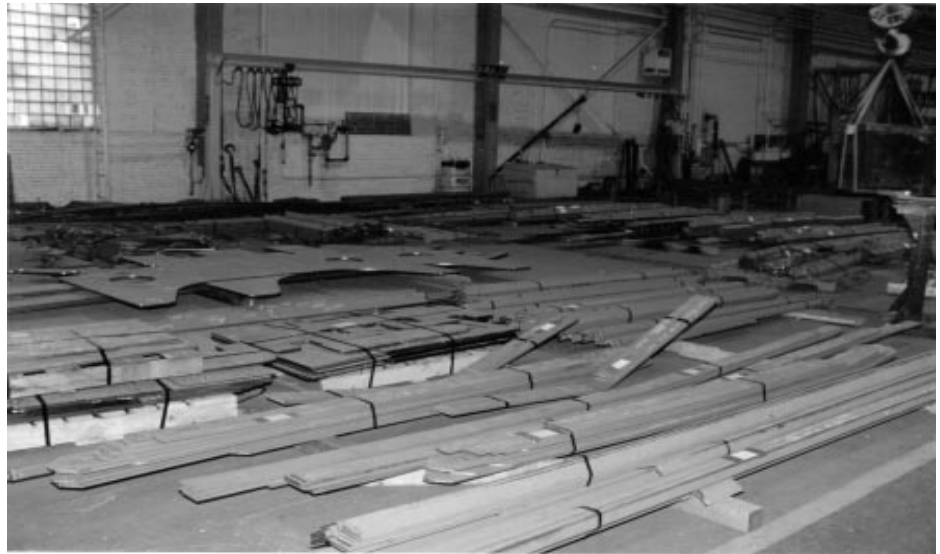
Chaque pièce est identifiée au moyen d'un numéro de pièce ainsi que du numéro du navire et du numéro d'élément. Les pièces sont ensuite placées dans des caissons ou sur des palettes pour en faciliter l'assemblage. (HSC95-0840-07)
