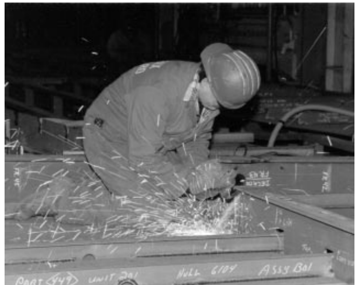
Rectification des pièces du module central de la coque du NCSM Edmonton. (HSC95-0840-09/10)
