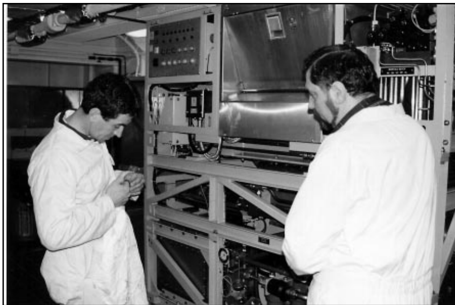
Dave Richards, représentant de Strachan and Henshaw (à gauche), et Dave Sigrist alors qu'ils procédaient à la mise en service du compacteur ultra-robuste, à la fin de mars. Le compacteur montré sur la photo, dont le couvercle avant est enlevé, est en mesure d'avalir toutes sortes d'articles comme des pièces de 4 sur 4 et des garde-rats et de réduire leur volume de 15 fois.
