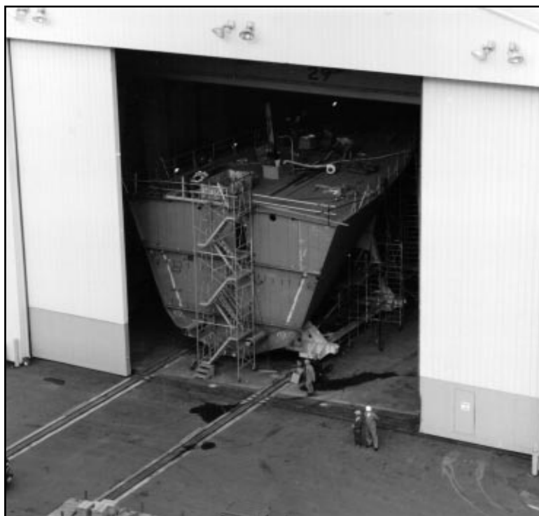
Le module d'étrave du NCSM Glace Bay . Tout juste derrière, se trouvent les modules central et arrière du Nanaimo . (HSC96-0721-05)
