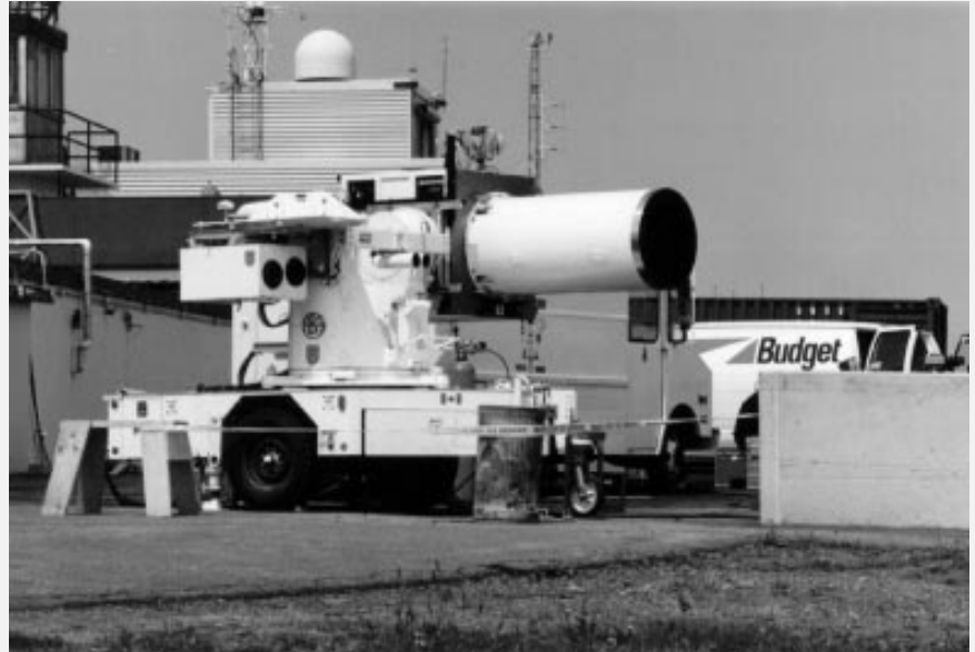
Le spectromètre d'imagerie infrarouge monté sur remorque du Centre de recherches pour la défense Valcartier a été utilisé pour mesurer les signatures IR de navires de guerre canadiens. Le spectromètre d'imagerie produit une série de graphiques multidimensionnels représentant les intensités IR d'un navire selon diverses variables.
