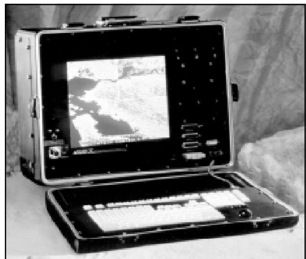
Fig. 1. Un système SASIE acheté pour fin d'évaluation technique a donné de bons rendements lors d'un tir de missile de classe *Halifax*. L'ordinateur de stockage des données de la version « Lite » du système SASIE (à gauche) et un poste de travail portable ont été installés à bord de la frégate NCSM *Charlottetown* afin de colliger et d'analyser les données de tirs de missiles lors de l'exercice militaire *El Morro Castle*.
