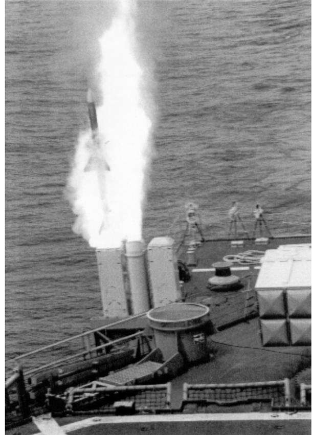
**Un des premiers lancements d'essai du système de missile guidé Mk-48 Mod 0 d'un navire d'essai des ÉU. (Photo courtoisie l'auteur.)**
