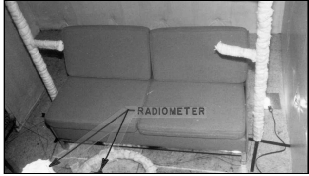
Fig. 4. Lequel de ces articles choisiriez-vous pour votre navire : le canapé bien rembourré ou la banquette traditionnelle du MDN? Ça n'a peut-être l'air de rien, mais la banquette représente un risque d'incendie énormément moins élevé grâce à son cadre d'acier, à son rembourrage en mousse de polychloroprène et à sa quantité minimale de matériau. L'utilisation de bois, de mousse de polyuréthane et d'une quantité de matériau non réglementé pour la fabrication de mobilier de série comme le canapé qu'on voit ici, d'ameublement de bar et d'autres « améliorations » sur le plan de l'habitabilité accroît radicalement la charge thermique à bord d'un navire.
