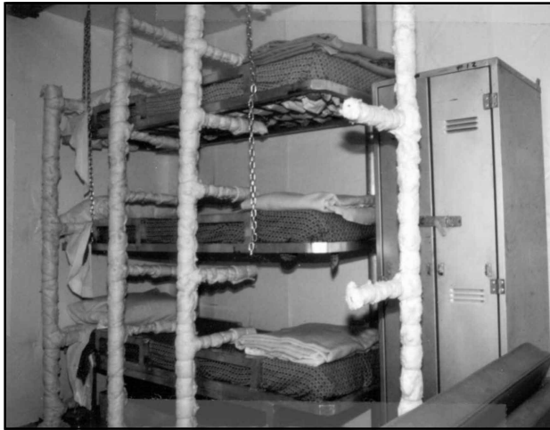
Fig. 2. On a aménagé cette enceinte de béton de 2,5 mètres x 3 mètres revêtue d'acier au CNRC à Ottawa à la fin des années 80 pour effectuer des essais de résistance au feu en grandeur réelle de divers matériaux d'ameublement des navires. L'enceinte était équipée d'une couchette à trois étages, d'une banquette et d'une armoire typiques. Comme cela est expliqué dans le texte et illustré à la fig. 3, la différence entre la cote de comportement au feu des ancien et nouveau matériaux d'ameublement était d'une évidence aveuglante.
