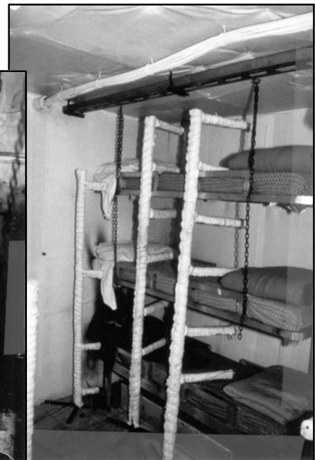
Fig. 3. Le choix d'un matériau en vue de son utilisation à bord d'un navire peut être un facteur déterminant du degré de risque d'incendie. La photographie à gauche montre tout ce qui restait d'un étage de couchettes munies de matelas en polyuréthane, chauffés à l'aide d'une flamme alimentée au propane pendant 2 minutes et demie. Comparez cela à l'état des couchettes munies de matelas de polychloroprène du même type (à droite), exposés à la même source d'inflammation et après plus de 30 minutes de combustion.
