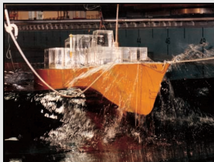
Fig. 2. Le ministère de la Défense nationale a effectué une série d'essais à l'aide d'une maquette flexible (hydroélastique) d'un navire de la classe Halifax pour mesurer la flexion, le cisaillement et les efforts de torsion de la poutre-coque produits par les vagues. On a utilisé pour d'autres expériences avec une maquette de navire de la classe Kingston (voir à la page 15) des transducteurs de pression à l'intérieur de l'enveloppe de la coque pour mesurer des charges locales d'impact des vagues sur le bordé de coque. On peut entrer des données d'essai sur maquette et des mesures réelles d'essai en mer de navire dans un programme d'analyse de sa structure pour évaluer des charges et des déformations structurales auxquelles un navire pourrait être soumis dans une route maritime. (Photo reproduite avec la permission de l'Institut de technologie océanique du Conseil national de recherches du Canada. Illustration reproduite avec la permission de Recherche et développement pour la défense Canada – Atlantique.)
