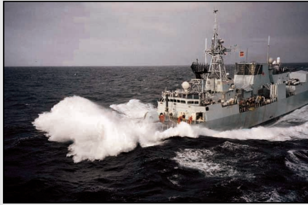
Fig. 1. Les avaries que risque d'entraîner le claquement contre la coque dépassent la déformation évidente du bordé des fonds et de la structure d'appui de la proue. Le dôme de sonar et les quilles de roulis peuvent également être avariés, et il se peut qu'il y ait de la fatigue structurale et du fouettement dans le mât et les antennes. (Photos du MDN)
