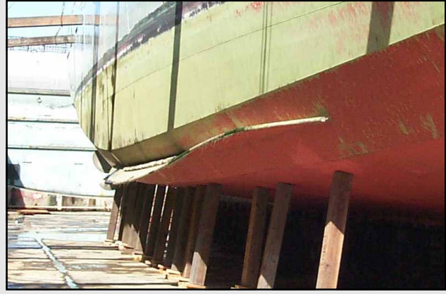
Fig. 1. Les avaries que risque d'entraîner le claquement contre la coque dépassent la déformation évidente du bordé des fonds et de la structure d'appui de la proue. Le dôme de sonar et les quilles de roulis peuvent également être avariés, et il se peut qu'il y ait de la fatigue structurale et du fouettement dans le mât et les antennes. (Photos du MDN)
