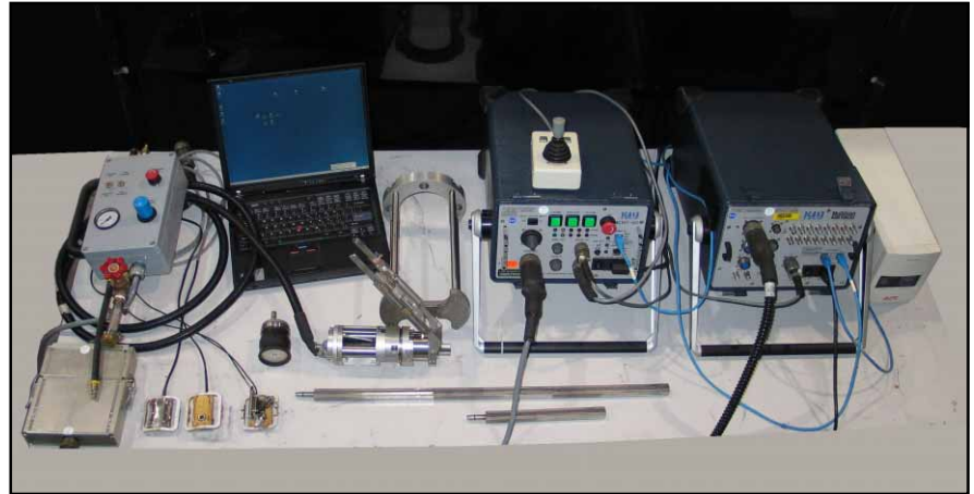
Fig. 1. Cette suite élaborée d'outils a été conçue spécialement pour l'inspection de bouteilles haute pression de sous-marin in situ . Au centre gauche, on trouve l'ordinateur portatif ouvert avec le scanneur cylindrique juste devant. En avant-plan à gauche, on voit les trois têtes de sonde du scanneur attachées à leur fil de connexion. Au centre droit, on trouve le moteur d'entraînement et, complètement à droite, l'unité d'acquisition de données et son gros câble de connexion noir qui le relie au matériel d'acquisition de données complètement à gauche. Les minces tiges en avant-plan sont les sections de rail sur lesquelles se déplace le scanneur.
