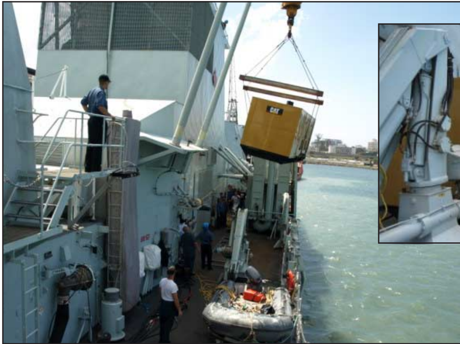
Les contraintes d'espace à bâbord, un mécanisme de levage guère idéal et des problèmes d'espace libre près de la superstructure ont compliqués l'installation.
