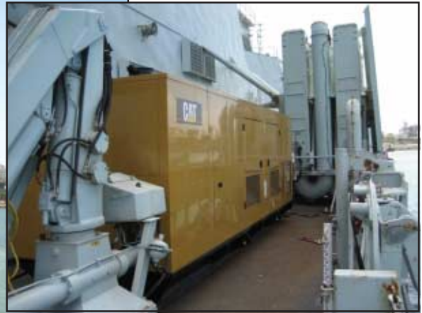
Les contraintes d'espace à bâbord, un mécanisme de levage guère idéal et des problèmes d'espace libre près de la superstructure ont compliqués l'installation.
