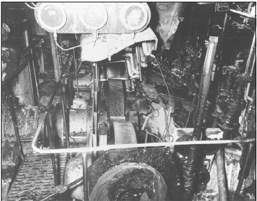
Fig. 1. La salle des machines noircie du NCSM Kootenay après la terrible explosion d'une boîte d'engrenage et l'incendie qui s'en est suivi témoigne des terribles événements survenus le 23 octobre 1969. Un palier de tourillon de pignon avant mal assemblé est au cœur d'une catastrophe qui aurait pu être évitée (toutes photographies propriété du MDN)
