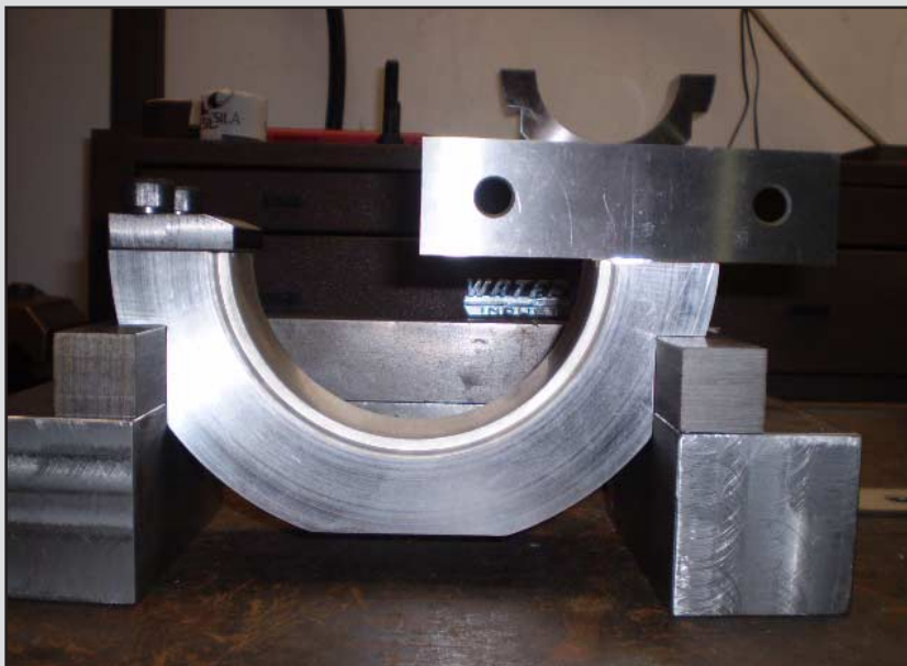
Figure 6. Les installations haligoniennes de Wärtsilä Canada ont fabriqué ce gabarit très précis pour mesurer la longueur de contact des coussinets de tête des bielles.
