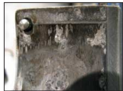
Figure 2. Les bielles présentent des signes d'usure de contact anormale de même que des transferts de matière importants entre le logement du chapeau de tête des bielles et les coussinets.
