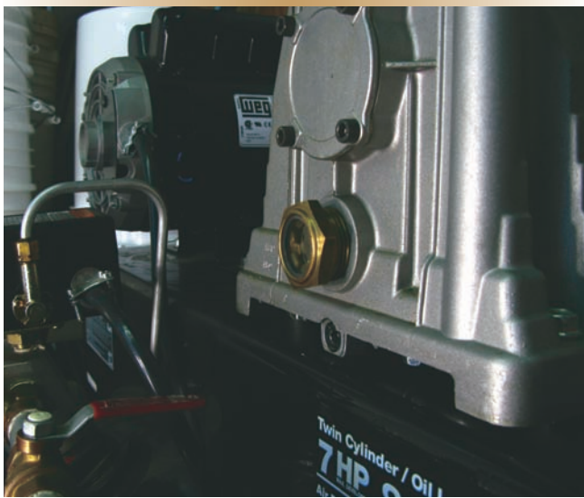
Figure 3. Résultat avant-après : le verre-regard BullsEye 3 D d'Esco donne une vue bien plus précise de l'état du lubrifiant dans le système. Source : Esco Products Inc.; http://www.escopro.com/3d-bullseye.html .
