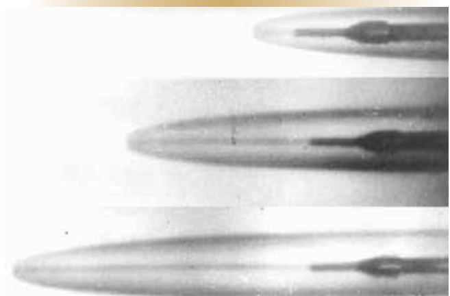
Figure 1 – Un projectile submergé qui se déplace à l'intérieur d'une supercavité autoformée a jusqu'à dix fois plus de vitesse qu'un projectile en contact direct avec l'eau de mer. (Y.N. Savchenko 2001)
