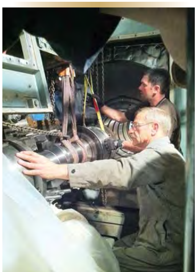
Figure 11 – Les pièces du puzzle se mettent en place. Une fois posée la nouvelle conduite d'échappement, l'auteur (devant) et le monteur Spartius Toope de l'IMFCS peuvent installer le nouvel arbre d'insertion de la turbine à gaz.
