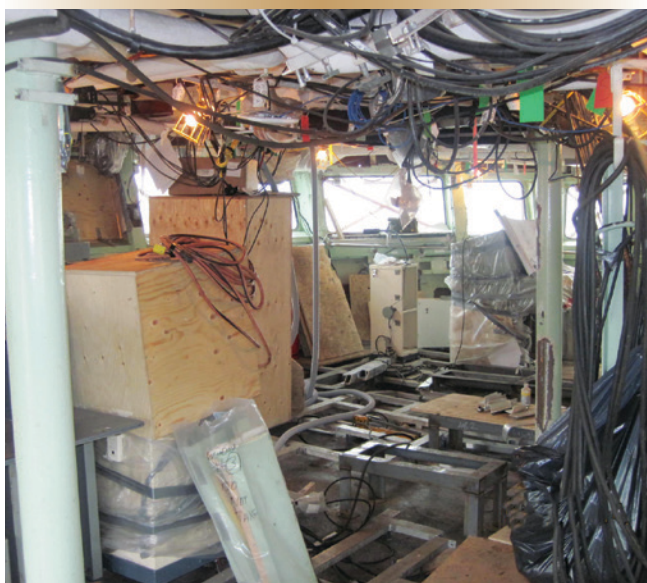
Le pont d'une frégate avant et après un carénage. D'intenses efforts ont été déployés lors du retrait et la pose des câbles, afin d'assurer le succès.
