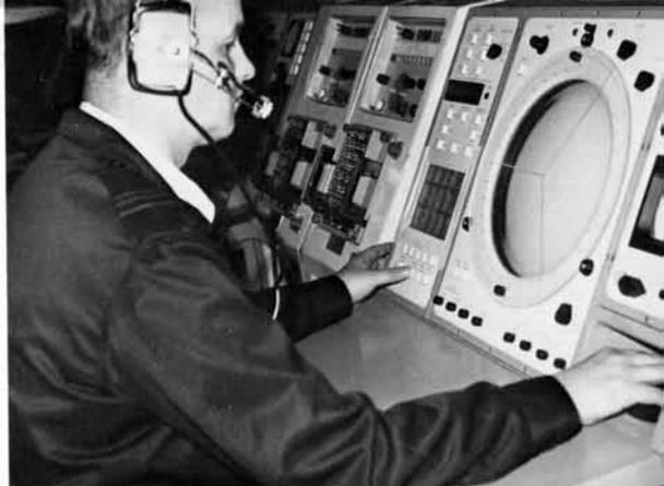
Des communications radios variées sont possibles depuis les basses jusqu'aux ultra-hautes fréquences. Un système télécommandé conçu et construit au Canada permet d'utiliser par bouton-poussoir l'équipement émetteur-récepteur situé à plus de 30 postes de fonctionnement sur le navire, mettant ainsi en œuvre un des systèmes de communications les plus perfectionnés et les plus souples utilisés à bord des navires de guerre dans le monde entier.
