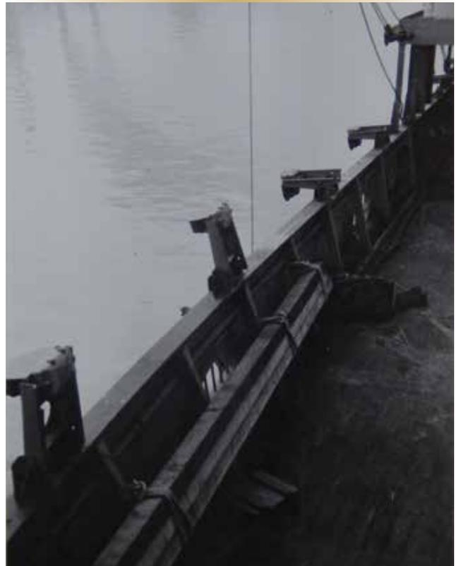
Rempart du HMS *Largs* montrant le raccord de quatre systèmes d'éclairage diffus camouflés, deux soulevés vers l'intérieur et deux déployés, dans le cadre des essais d'approches Clyde, 1942.
