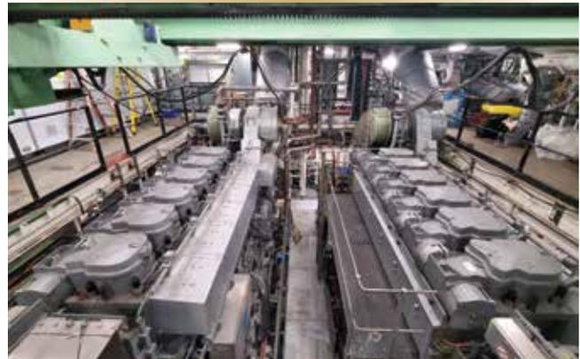
Figure 1. Deux des quatre moteurs diesel MAN de 3 600 kW du NPEA qui fournissent de l'énergie électrique pour les systèmes de propulsion et les systèmes électriques des navires.
