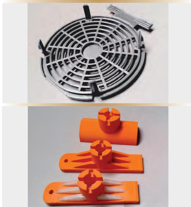
Figure 1. La FA avec le plastique ABS est utile pour les pièces facilement endommagées ou perdues, comme les couvercles de ventilateur et les outils d'armement des marqueurs fumigènes.
