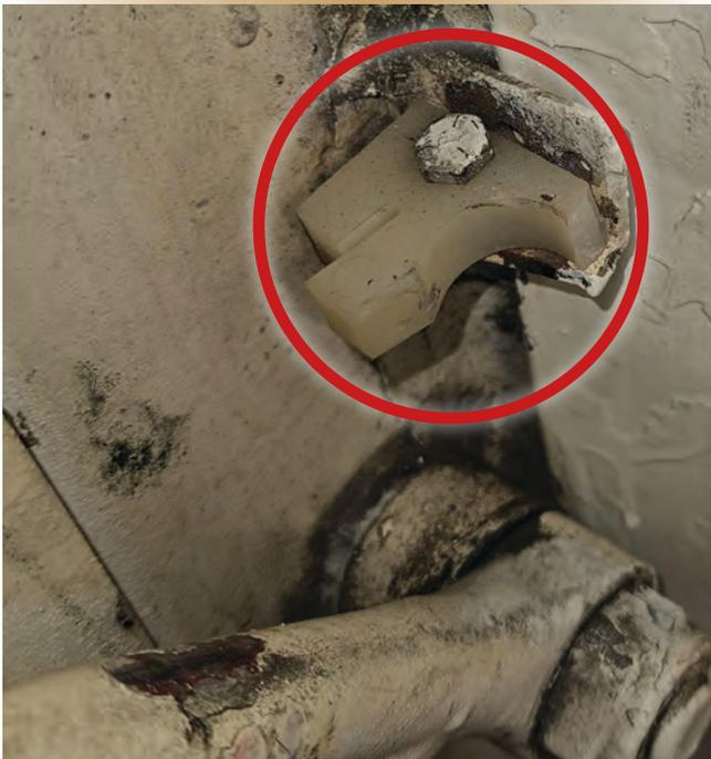
Figure 4. Dispositif de retenue de porte brisé. Le côté droit de l'encoche du dispositif de retenue s'est brisé et détaché, ce qui a empêché la poignée de porte de se fixer en place.
