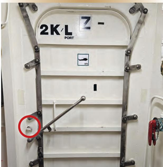
Figure 1. Porte étanche à action rapide à bord d'une frégate de classe *Halifax*.
