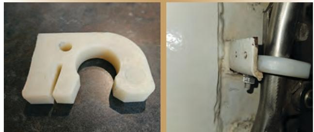
Figure 2. Le dispositif de retenue en polyéthylène actuellement utilisé.
