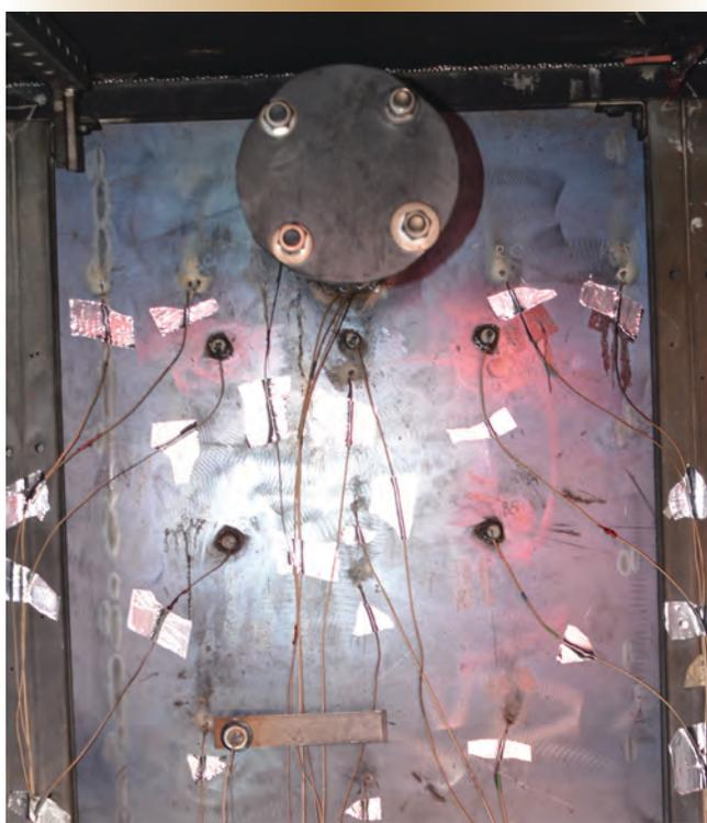
Figure 4. Thermocouples fixés à l'arrière de la cloison d'essai.
