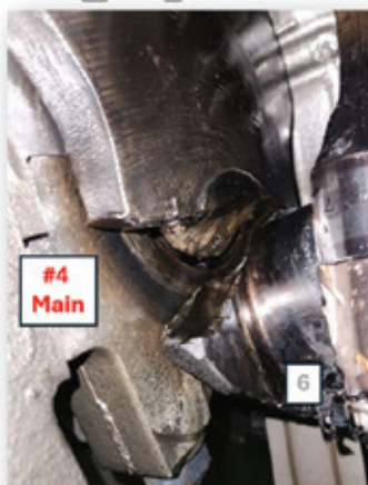
Emplacement des plaques de butée et des dommages au vilebrequin
