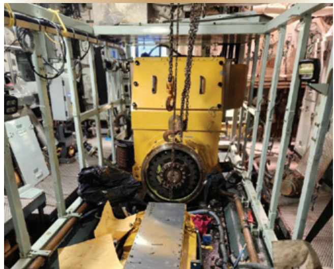
Boîtier démonté, générateur déplacé, moteur endommagé retiré
