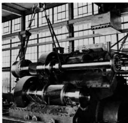
5. ... et le pignon d'entrée et embrayage de la machine principale sont placés dans le carter supérieur.
