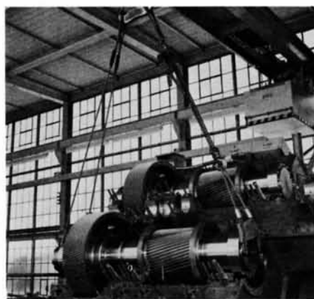
4. ... le pignon et engrenage intermédiaire de la machine principale
