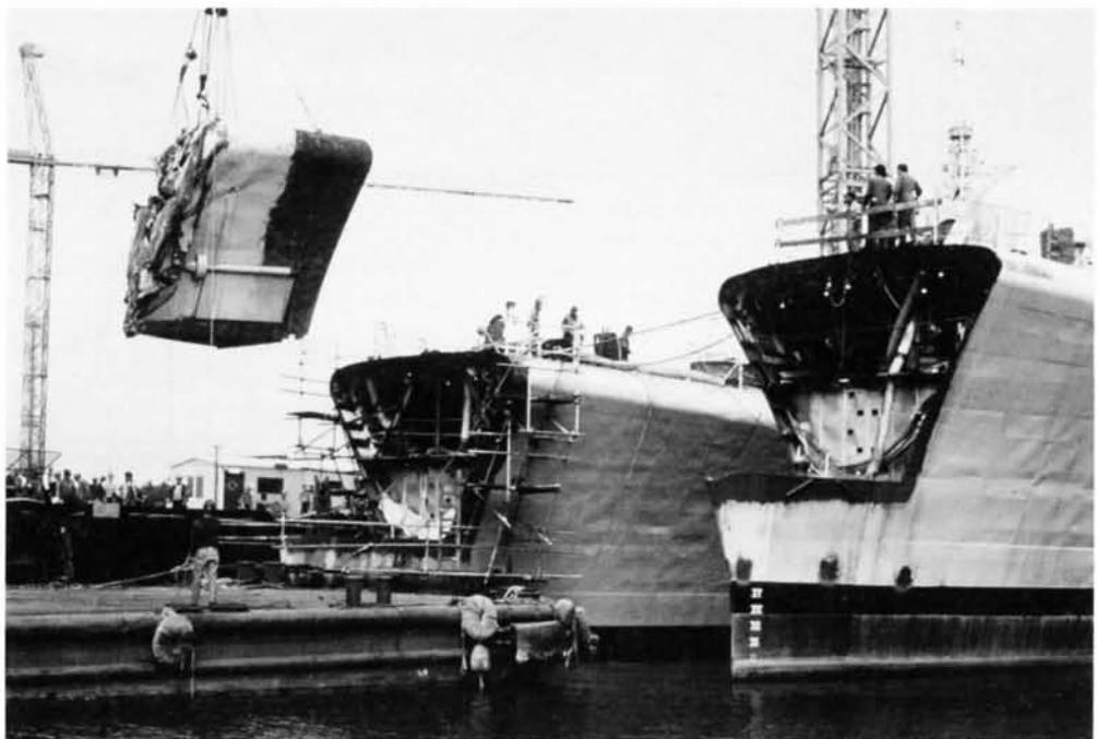
Fig. 5 La proue est déposée sur la jetée B et les dommages subis à la ligne des 65° sont clairement visibles. (Photo par R.L. Hopkins, QHM Esquimalt.)
