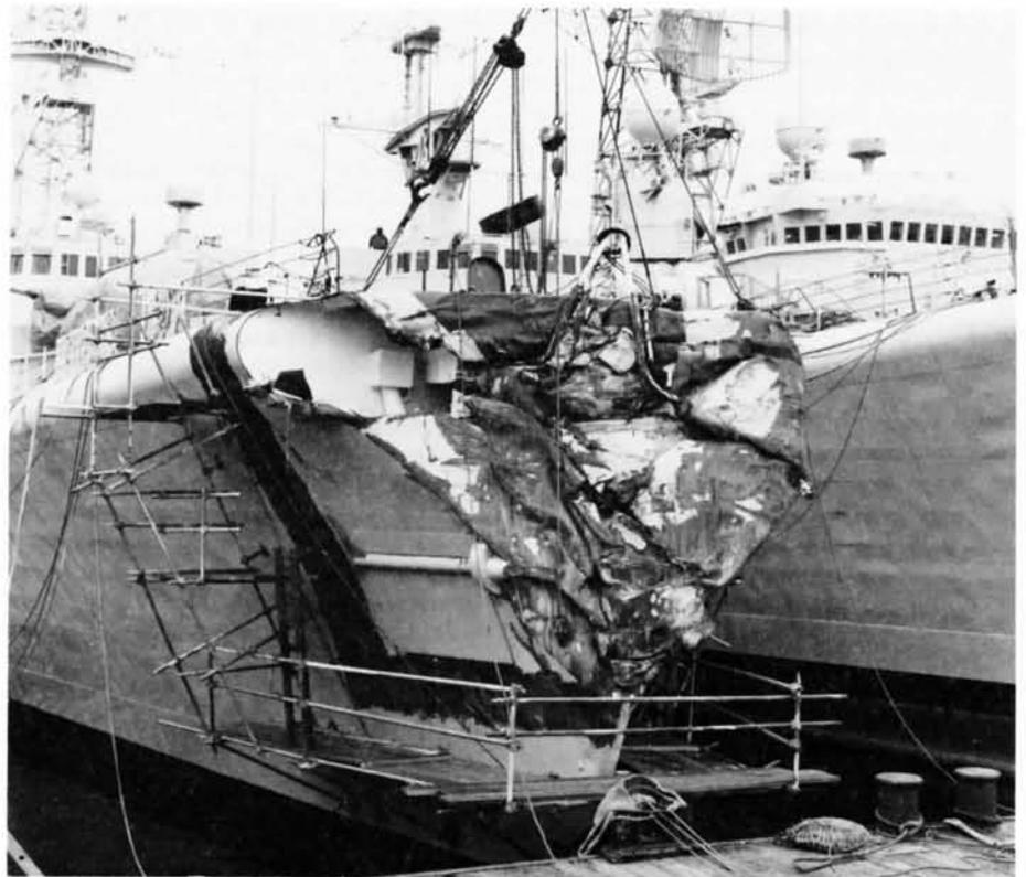
Fig. 2 On s'apprête à enlever la proue écrasée du *Kootenay*. Le navire n'a subi aucun dommage au delà de la cloison d'abordage.
