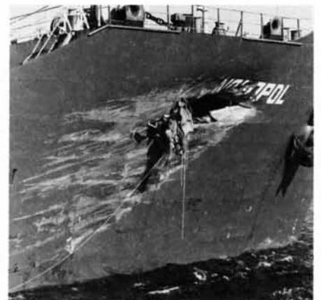
Fig. 1 Section de proue du MV *Nordpol* à la suite de la collision. On peut apercevoir une pièce écrasée de la proue du *Kootenay* saillant de la brèche.
