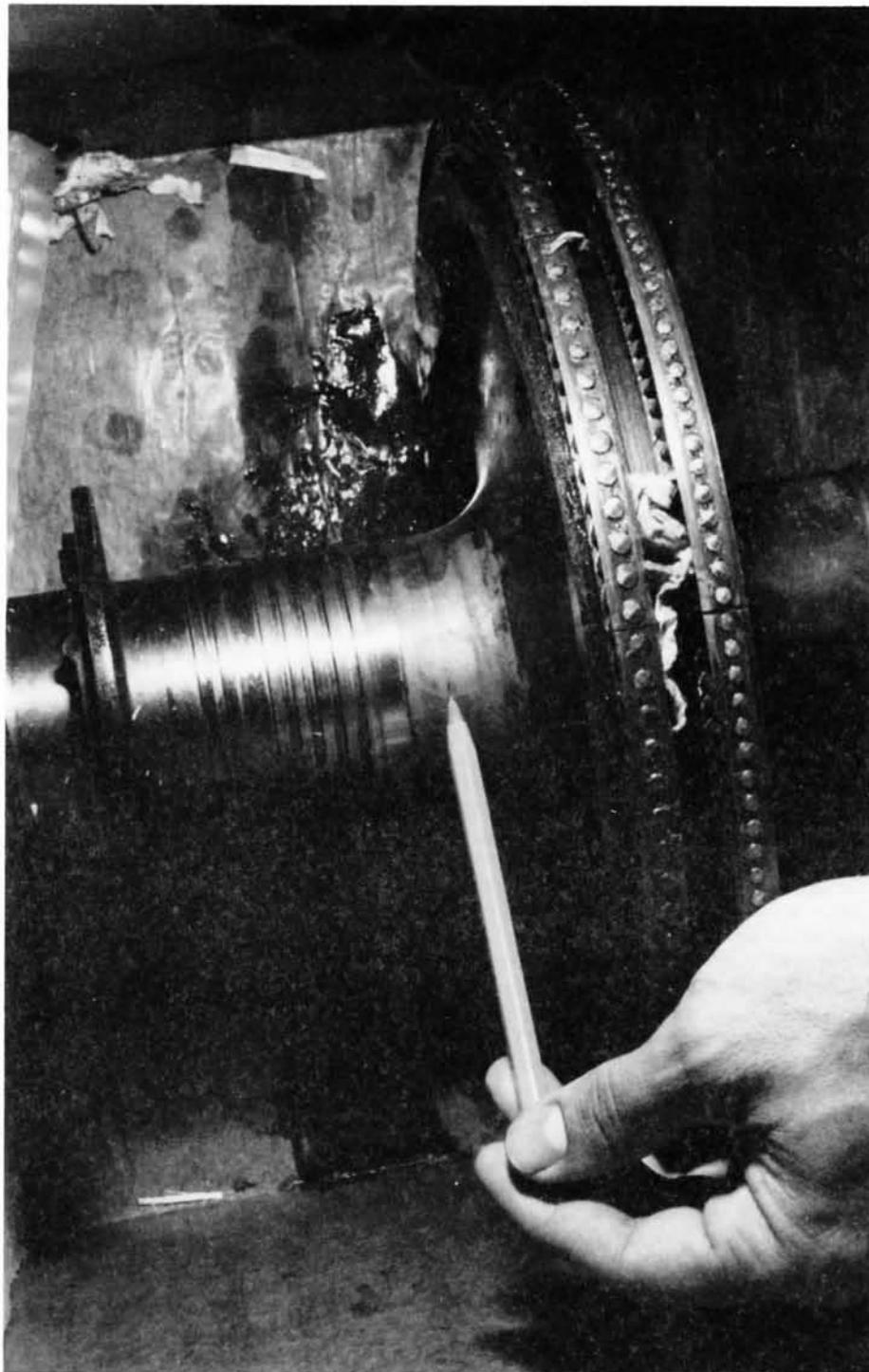
Fig. 4. Un procédé de décapage au bain d'acide a servi à révéler ce point chaud.
