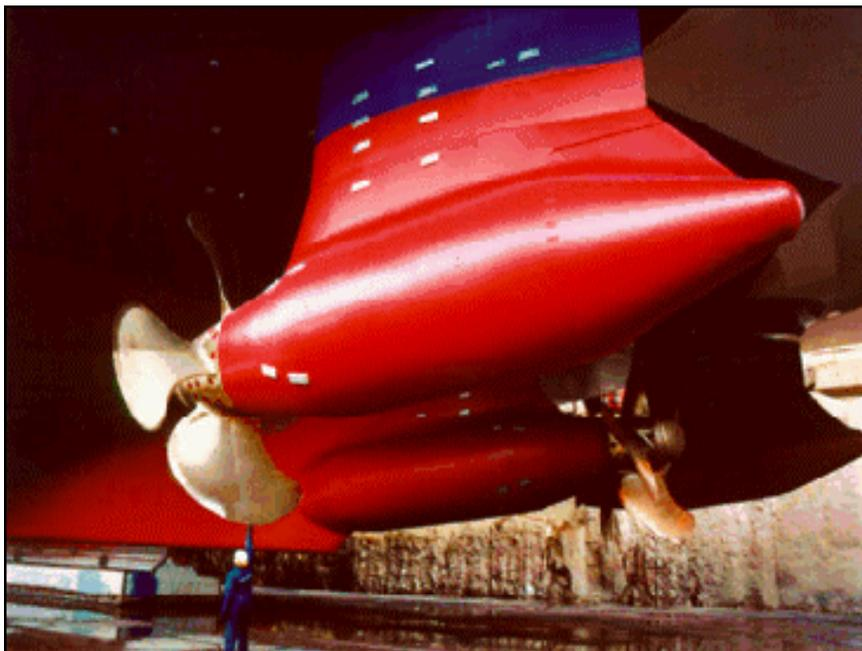
**Fig. 1. Un système de propulsion par nacelles électrique, tel que les trois unités ABB Azipod® installées sur la navire *Voyager of the Seas* de Royal Caribbean International, offre des avantages uniques dans la simplicité du dessin. Dans cette configuration, les nacelles du tribord et du bâbord pivotent, mais la nacelle du centre est fixe. (Droits d'auteur 2002 ABB)**
