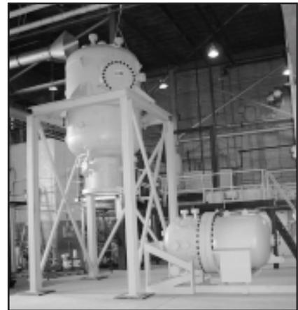
Le banc d'essai du Système de sauvetage des sous-marins du CETM (montré ici pendant le montage) sera utilisé pour une validation et une vérification indépendante des systèmes respiratoires incorporés (SRI) d'urgence à bord des sous-marins de classe *Victoria*. (Photos courtoisie du CETM Montréal)
