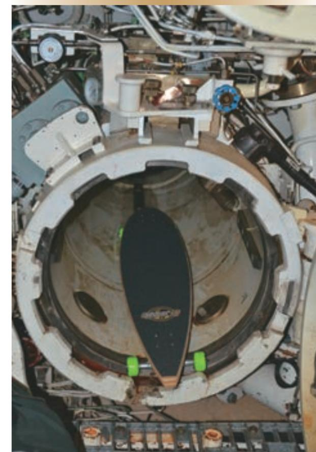
Cette planche d'examen de tube d'accès cinétique de sous-marin (SKATE) s'est avérée très utile comme plate-forme roulante de mécanicien durant l'inspection des tubes lance-torpilles.
