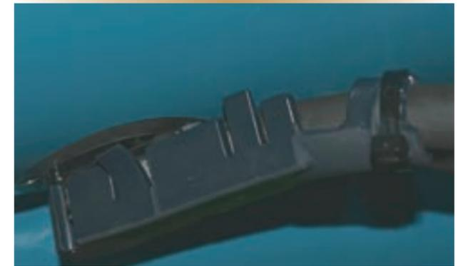
Cette « botte » en caoutchouc à haute densité a été conçue par le Naval Undersea Warfare Center des États-Unis pour protéger les extrémités du câble A à l'intérieur du tube lance-torpilles durant le lancement.
