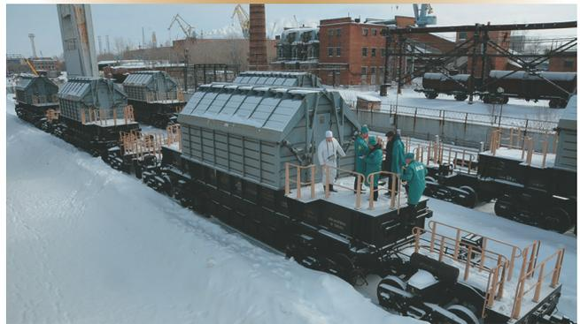
Une fois les assemblages de combustible nucléaire usés stockés en toute sécurité, un train spécial sert d'entreposage temporaire avant le long périple visant à livrer la cargaison radioactive à l'installation de stockage de Mayak dans les monts Oural.
