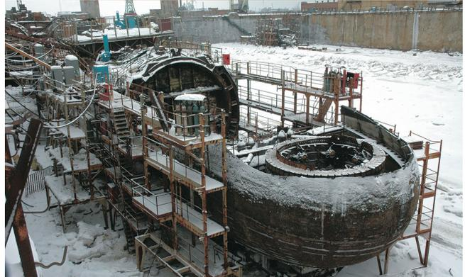
Un SNA de la classe *Victor III* (à gauche) au chantier naval Zvyozdochka de Severodvinsk et 2 mois plus tard, le même vaisseau (à droite) à demi-démantelé.
