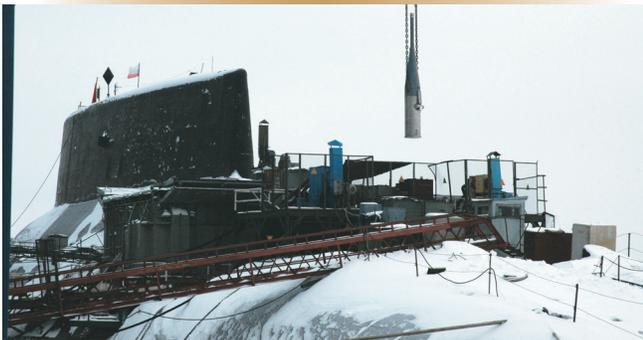
Pour reprendre le carburant de sous-marins nucléaires russes, il faut soulever les assemblages de combustible nucléaire usés des réacteurs dans des supports de transfert, puis les installer solidement dans des conteneurs pour les expédier en toute sécurité vers une installation de traitement loin dans les monts Oural.
