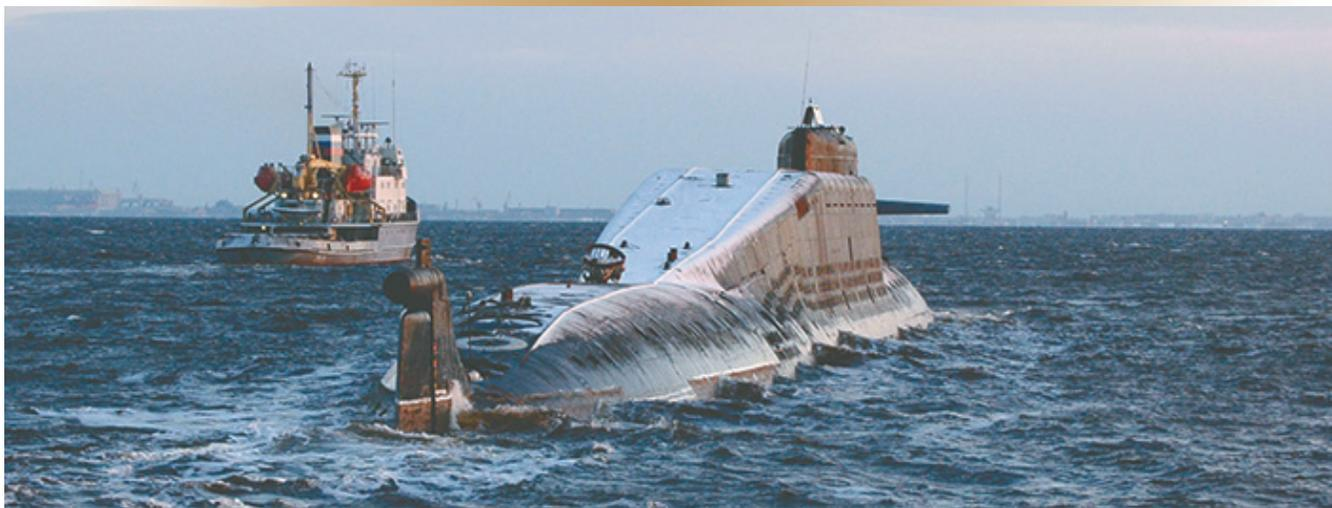
Un SNLE russe de classe DELTA III qui est remorqué de Mourmansk au chantier naval de Severodvinsk pour une reprise de carburant et un démantèlement.
