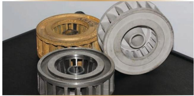
Figure 2 – Trois versions d'un rotor de compresseur Nash : celle à l'avant à gauche est la reproduction obtenue avec la fabrication additive au laser; celle derrière est la pièce originale en laiton; et celle à droite est une reproduction en plastique produite avec l'impression 3D.
