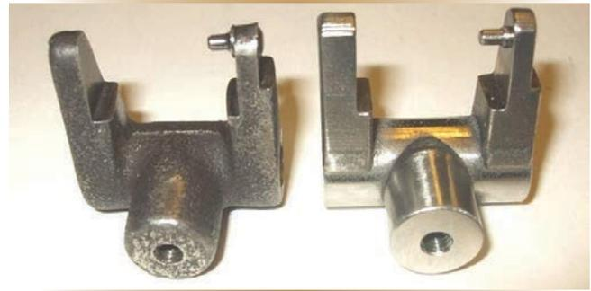
Figure 1 – Ce composant de débitmètre de carburant (pièce originale à gauche) a été reproduit avec la fabrication additive. La pièce reproduite est en service depuis plus de deux ans et elle n'a connu aucune défaillance.
