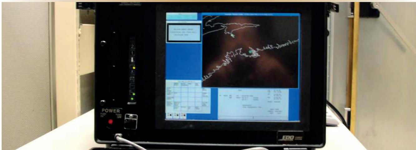
Le poste de travail d'un système d'affichage de liaison portable (SALP) renforcé et autonome et un sous-système radio HF.
