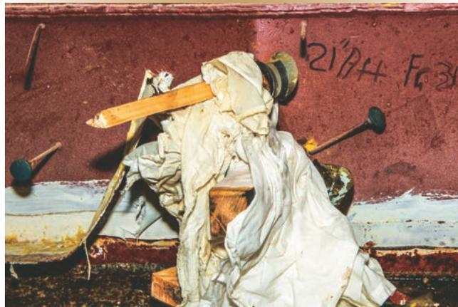
Les techniciens de coque du navire ont utilisé des bouchons et des cales pour arrêter l'infiltration d'eau causée par les hautes vagues de deux à trois mètres à l'extérieur de l'atelier de mécanique.
