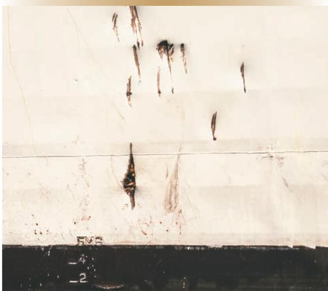
Les dommages causés par la barge à l'extérieur de l'atelier de mécanique et de la salle des machines avant.
