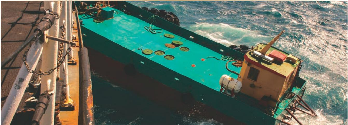
Cette barge de 200 mètres cubes s'est détachée dans la baie de Souda, en Crète, et elle a endommagé la coque du NCSM *Fredericton*. Le vent et les vagues ont augmenté rapidement, ce qui a permis à la barge de se détacher et de causer d'importants dommages à la coque du navire, à un mètre au dessus de la ligne de flottaison.
