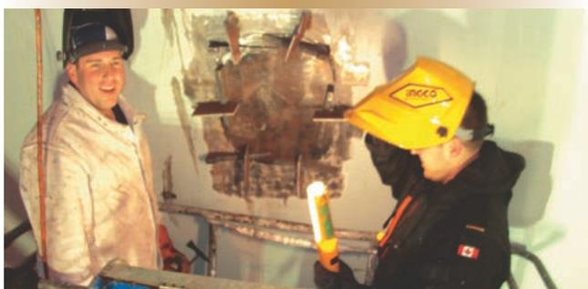
Le Mat 1 Matthew Boucher et le Mat 2 Larivière-Lacombe, techniciens de coque du *Frederickton*, utilisent des valets et des cales pour faire l'ajustement serré d'une plaque de renfort et de la coque avant de souder le tout en place.
