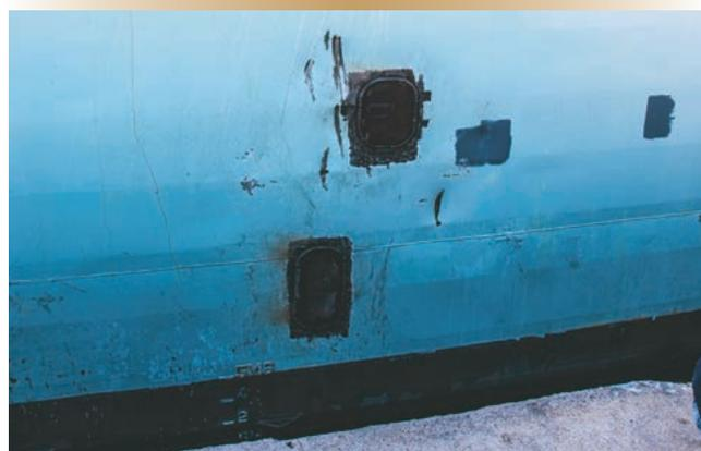
La réparation de la coque à l'extérieur de l'atelier de mécanique et de la salle des machines avant. Les techniciens de coque du navire ont soudé deux plaques de renfort à la coque du *Frederickton*.
