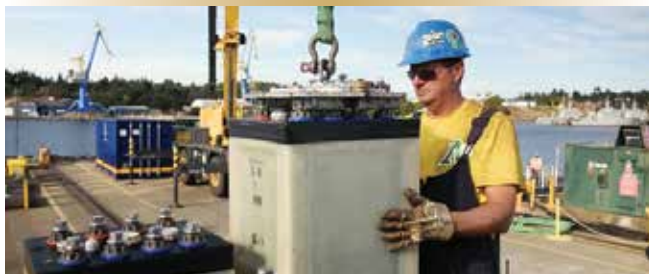
Chaque accumulateur de 550 kg sert également de ballast pour assurer la stabilité essentielle du sous-marin.
