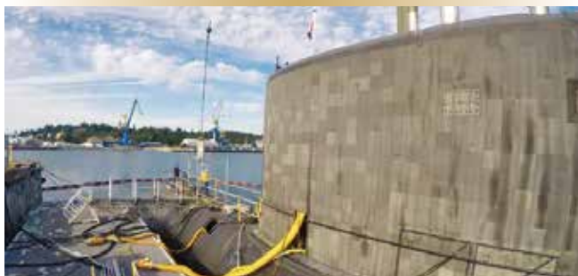
Tous les 480 accumulateurs de batterie ont dû être retirés de chacun des sous-marins avant que les remplacements du Victoria soient installés à bord du Chicoutimi .
