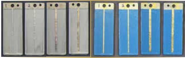
Figure 2. L'avant et l'arrière des échantillons revêtus d'une couche d'époxy (à gauche) et d'une couche antisalissure (à droite) après qu'un défaut intentionnel a été entaillé de chaque côté, et avant qu'ils soient immergés.
