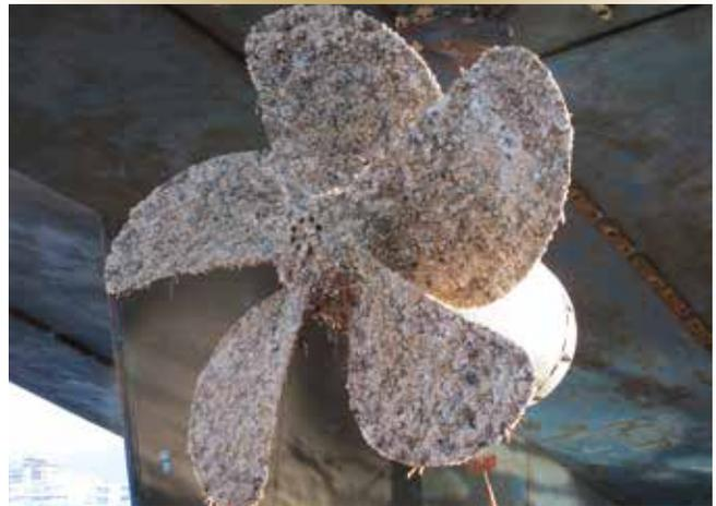
Figure 1. L'hélice obstruée d'un navire qui est resté amarré pendant 18 mois à Victoria, en Colombie-Britannique. L'important l'encrassement biologique a dû être enlevé par voie mécanique, ce qui a augmenté le risque de dommages à l'hélice.
