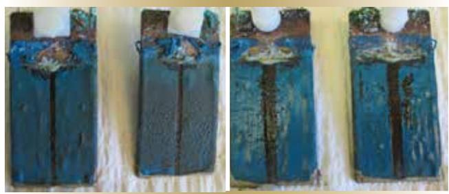
Figure 4. L'avant (à gauche) et l'arrière (à droite) des échantillons revêtus d'une couche antisalissure avec protection cathodique après 18 mois.
