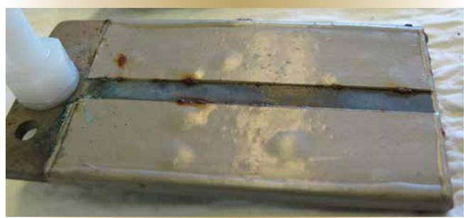
Figure 5. Des échantillons revêtus d'une couche d'époxy après avoir été immergés pendant 18 mois, présentant des cloques importantes à de nombreux endroits.
