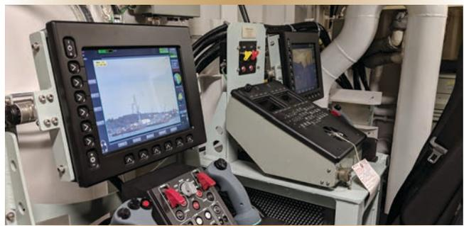
Figure 5. Les consoles d'opérateur à distance arrière du NCSM *Winnipeg*.
