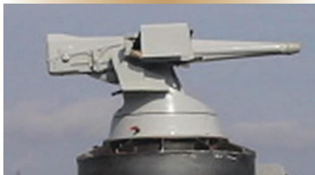
Figure 2. Une tourelle navale OTO Melara louée a été installée à bord du NCSM *Summerside*.<sup>3</sup>
