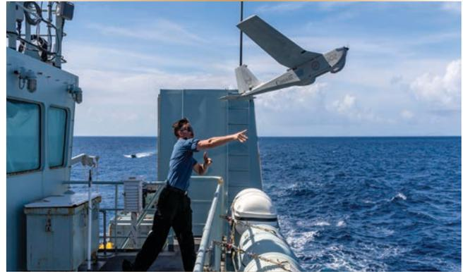
Figure 2. Lancement manuel d'un SATP Puma à partir d'un NDC de classe *Kingston*.
