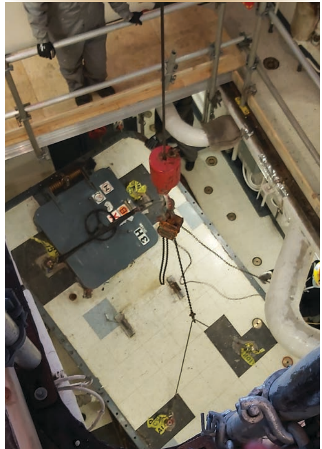
Figure 1. Le personnel de l'IMFCS dépose le placard à joint plastique dans la salle des machines auxiliaires arrière du NCSM Ville de Québec .
