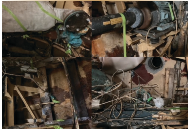
Figures 2a & 2b. Le premier obstacle consistait à terminer l'enlèvement des nombreux éléments gênants à l'intérieur du navire qui bloquaient l'accès complet aux membrures, aux lisses et au bordé de coque.
