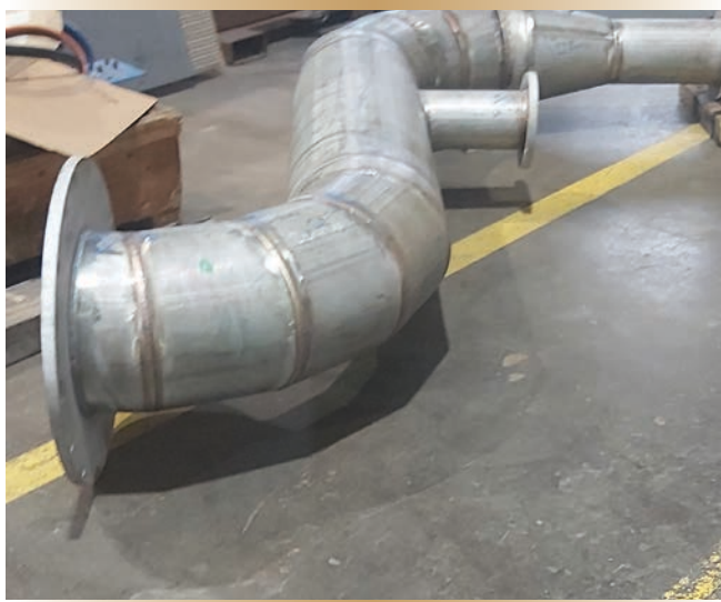
Figure 7. Une partie de l'entrée d'air et de l'échappement du nouveau moteur est fabriquée par l'installation de maintenance de la flotte Cape Scott.
