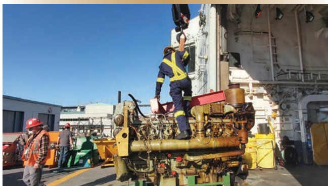
Figures 2a et 2b. Un ancien moteur MWM 602 est gréé et prêt à être soulevé hors de la salle des machines auxiliaires arrière, puis ramené à terre.
