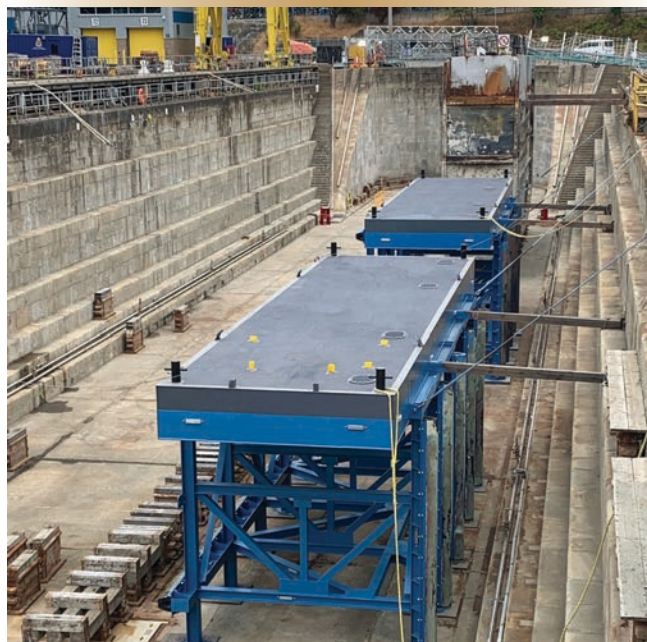
Figure 1. Ces deux barges de défense de chameau sous-marines de la Marine américaine, prêtées à la MRC à titre semi-permanent, ont été entièrement remises à neuf et remises en service par l'Installation de maintenance de la Flotte Cape Breton à Esquimalt (C.-B.).
